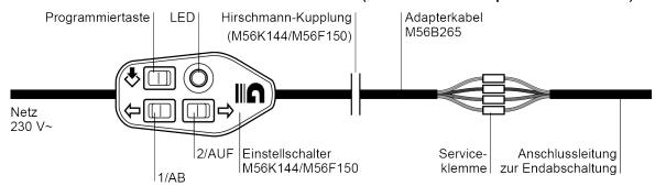
Anschluss mit Einstellschalter M56F151 mit Serviceklemme
